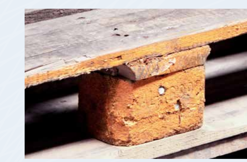
Verunreinigungen, die an Ladegüter abgegeben werden können, z.B. Farbe, Öl, Geruch, Schimmel, Stockflecken etc.
