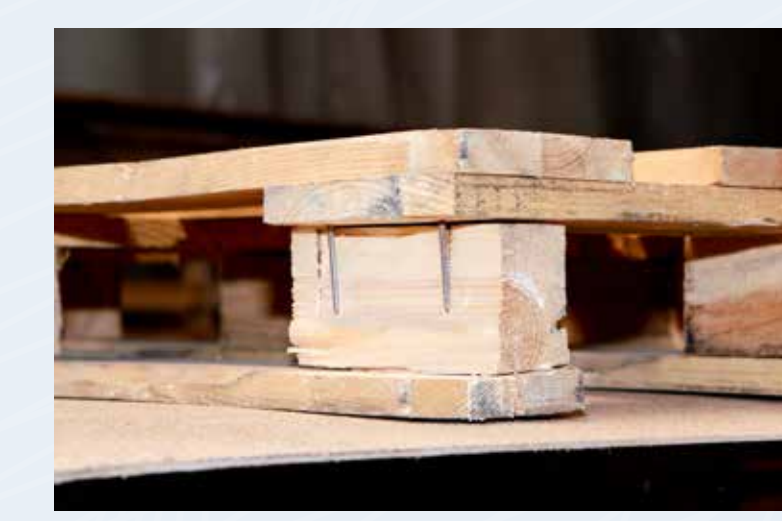
Sichtbare Befestigungselemente z.B. Nägel
