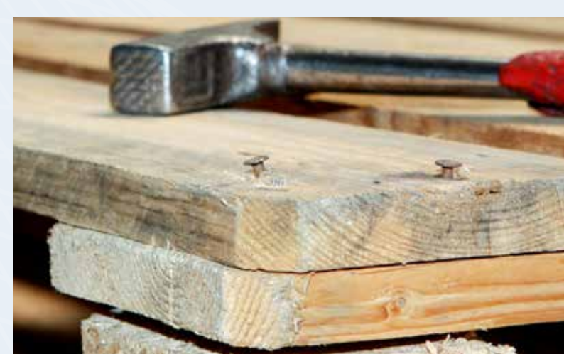
Einschlagen herausstehender Befestigungselemente
