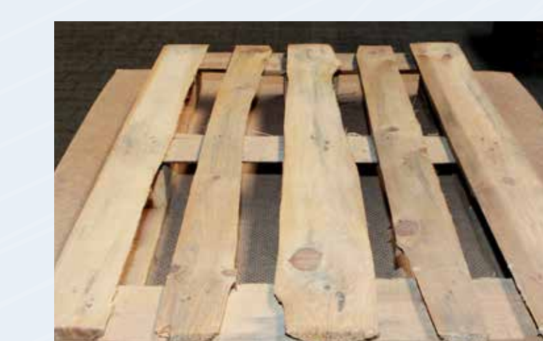
Unzulässiges Bauteil, z.B. untermäßig, morsch, Baumkante
